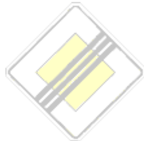
Ende der Vorfahrtstraße
